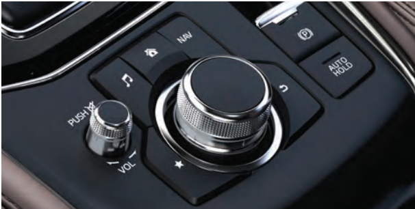
CENTER COMMANDER ใช้ควบคุม Mazda Connect ผ่านเมนูคำสั่งบนจอ Center Display จัดวางในตำแหน่งที่ผู้ขับขี่ใช้งานได้อย่างสะดวกสบาย ช่วยเพิ่มความปลอดภัยในการขับขี่
