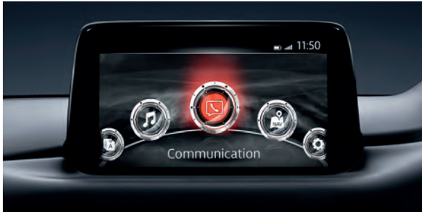
CENTER DISPLAY จอทัชสกรีน ขนาด 8 นิ้ว แสดงเมนูคำสั่งของ Mazda Connect และตั้งค่าการใช้งานอื่นๆ หรือเรียกดูข้อมูลผ่านระบบสั่งงานด้วยเสียง Voice Recognition
